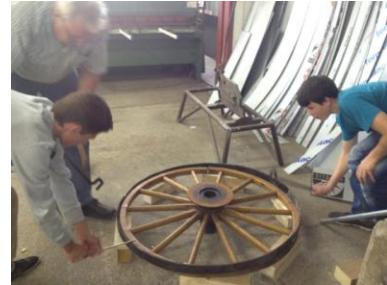
Nun muss es schnell gehen, damit der heiße Reifen den Radkörper nicht beschädigt. Noch ein prüfender Blick des „Meisters“ und das OK an seine Helfer. Jetzt ist Abkühlung in einem Wasserbad angesagt. Das Material des Stahlreifens zieht sich zusammen. Es umschließt den Holzkörper nun so fest, dass der Stahlreifen, also die
